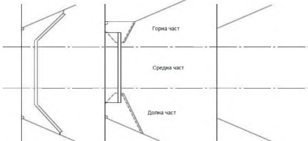
Типичен шпангоут в товарен трюм Зона за измерване на дебелината (A)
