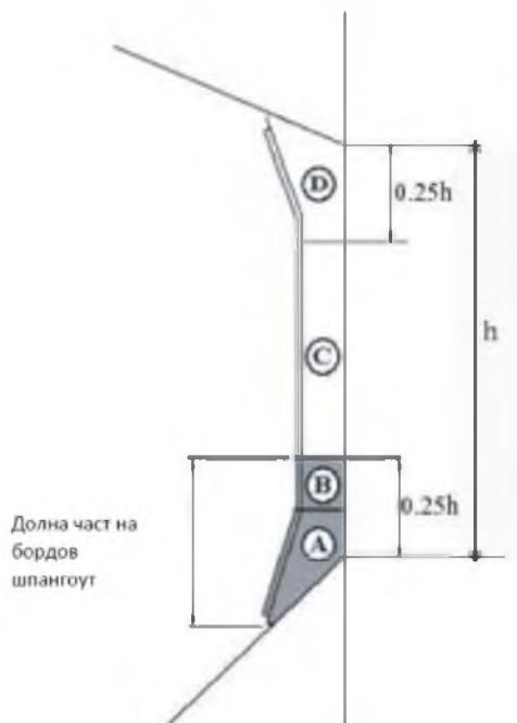
Фиг. 1 – Зони на бордови шпангоути и скоби на корпуса
