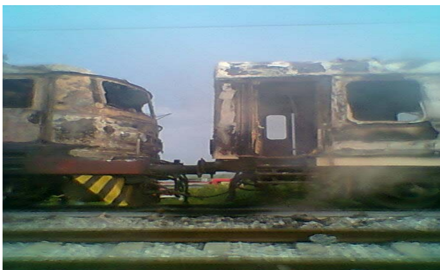
Опожарени локомотив и вагони от влак № 2615
