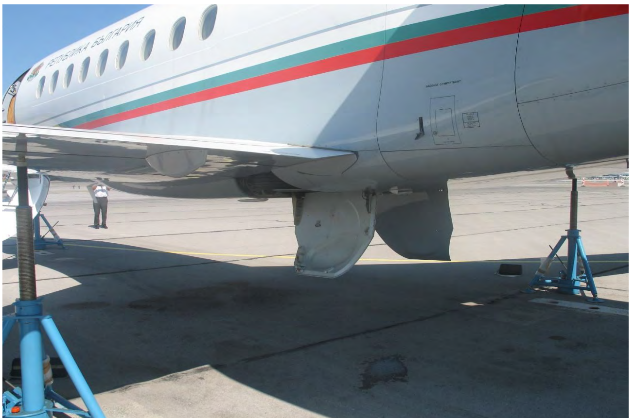
Фиг. 29 Ръчката е на прибрано положение, щитките на основните колела остават в пуснато положение.
