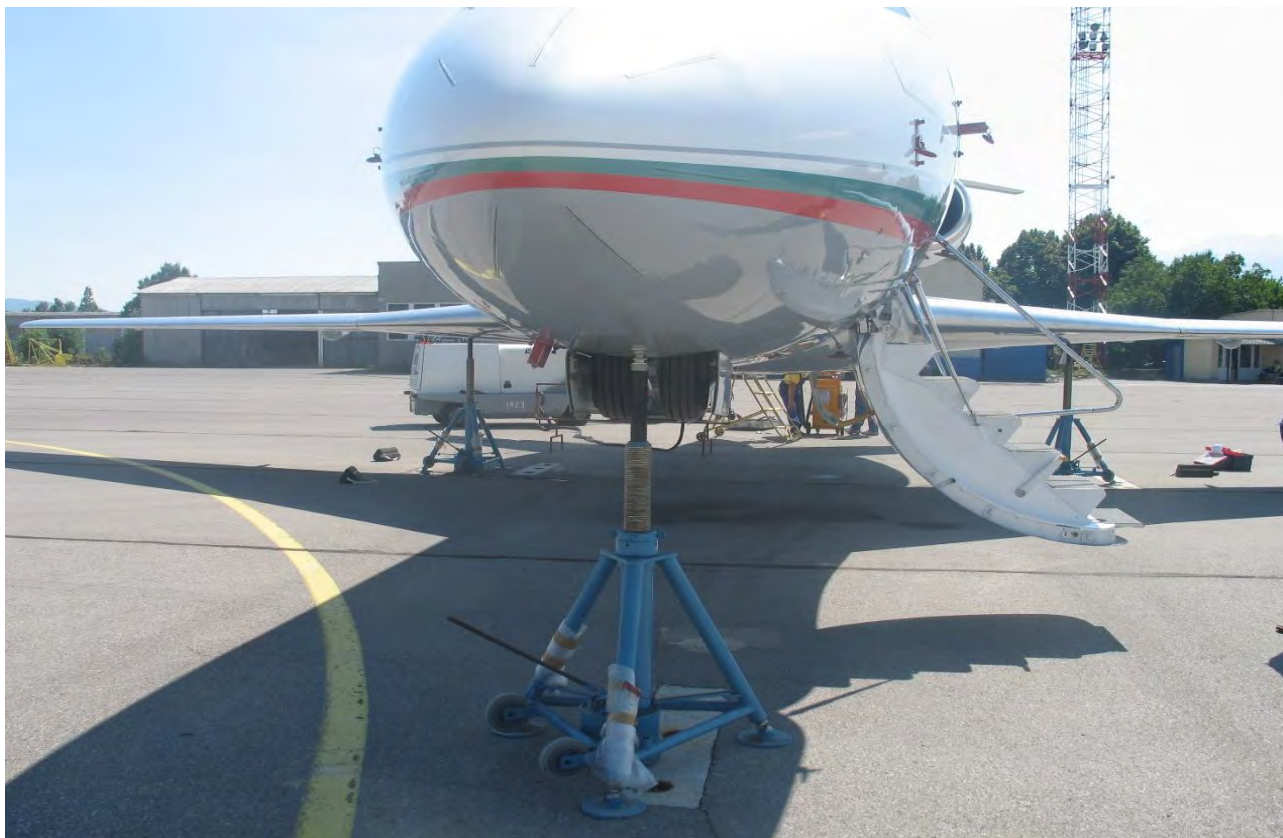
Фиг. 30 Ръчката е на прибрано положение, носовата стойка не е заключена в прибрано положение.
